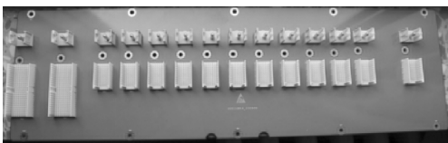
图3 综合通信分站背板模块
